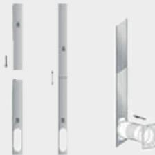
**Paso 4:** Cierre la ventana para asegurar el kit en su lugar. Debe mantener el kit de ventanas firmemente en su lugar; asegúrelo con cinta adhesiva si es necesario. Se recomienda sellar el espacio entre el adaptador y los lados de la ventana para lograr la máxima eficiencia.
