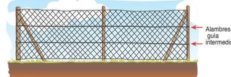
**8** Aplique tensión gradualmente, poste a poste y fije utilizando varillas de amarre como indica la figura. Asegure el alambre guía con una grapa.
