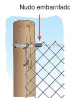
**6** Instale alambres guía intermedios según altura de la malla.
